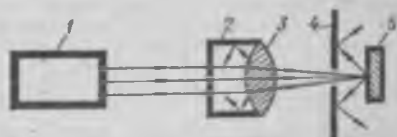
Рис. 7.1. Схема экранирования отраженного лазерного излучения:
