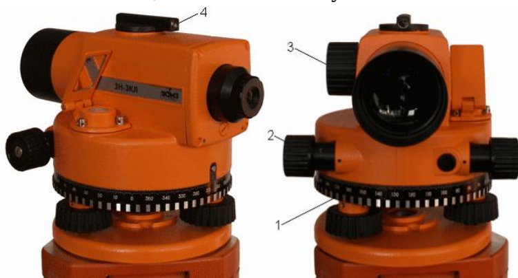
6.22-rasm. Kompensator va limbli aniq nivelir 3N-3KL:
