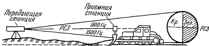
Рис. 161. Схема планировки земляного корыта с использованием прибора ПУЛ
