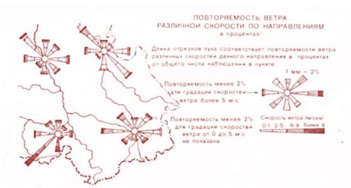
Рис. 42. Применение локализованных диаграмм для характеристики повторяемости и скорости ветра
