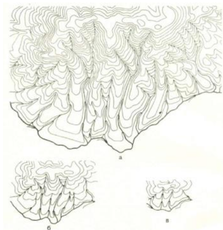
Рис. 75. Генерализация рельефа в горизонталях а исходное изображение в масштабе 1 : 200 000; б — изображение в масштабе 1 : 500 000. в — изображение в масштабе 1 : 1 000 000
