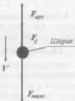
Рис. 1.9. Принципиальная схема работы вискозиметра
