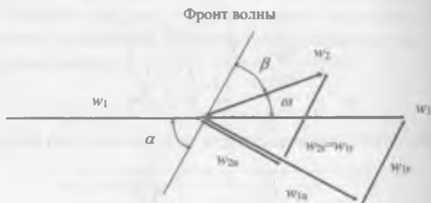
Рис. 7.18. Схема косоугольного скачка уплотнения
