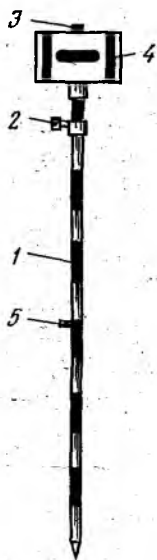
Рис. 62. Веха дальномера внутрибазного ДВ-20
