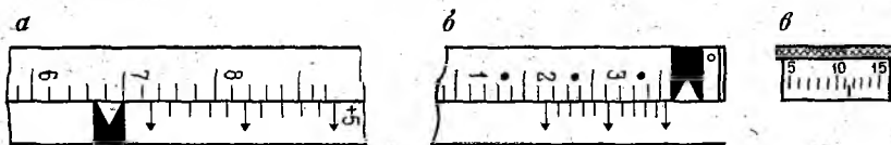
Рис. 58. Отсчет по дальномерной рейке Редта
