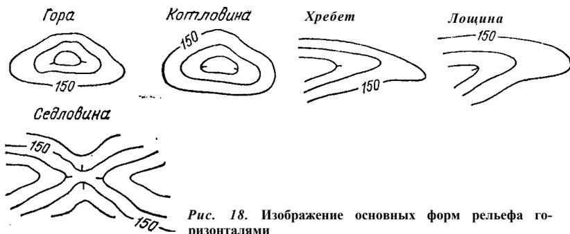
Рис. 18. Изображение основных форм рельефа горизонталями
