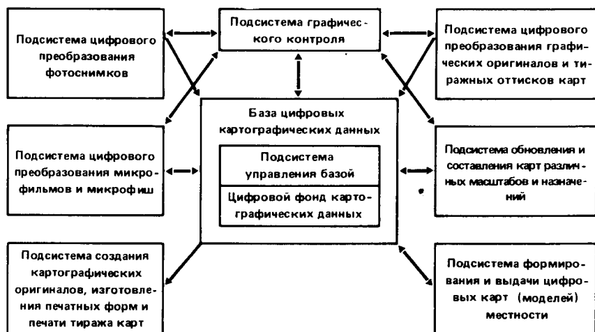
Рис. 65. Структурная схема автоматизированной картографической системы
