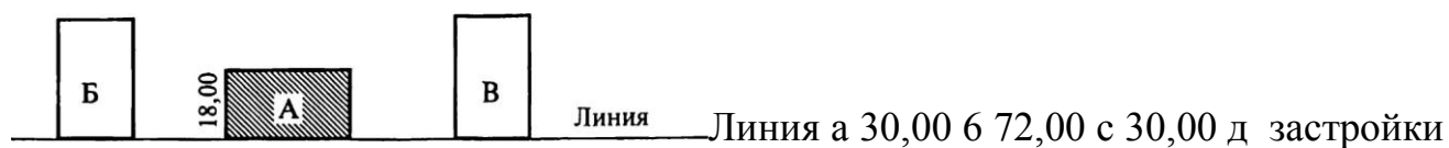
7.3. Графический способ определения размещения здания для разбивки: а...д — углы зданий
