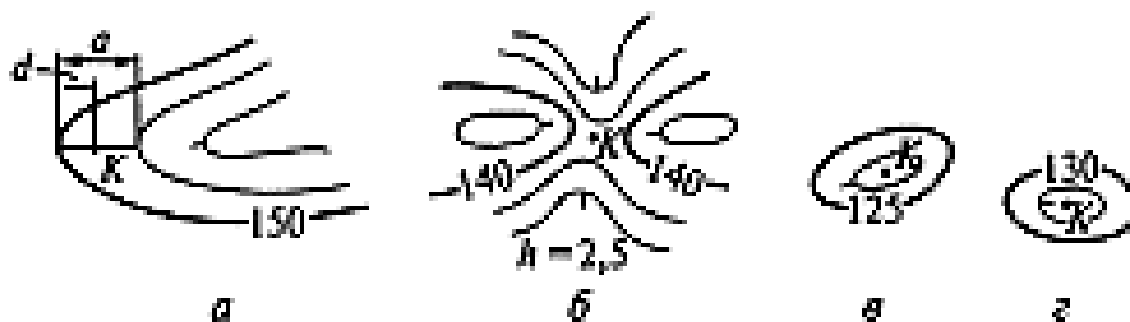
Рис. 4.8. Определение отметок точек по горизонталям: а ...г — схемы при высоте сечения h = 2,5 \text{ м}
