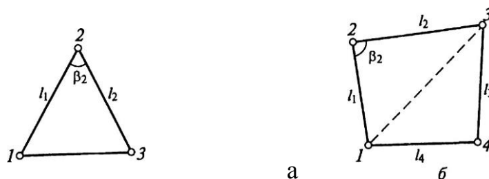
Рис. 23.1. Геометрические фигуры для определения площадей участков: а — треугольник; б — четырехугольник
