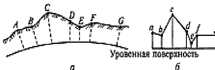
Рис. 1.5. Изображения местности: а — разрез; б — профиль
