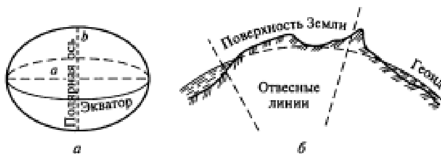
Рис. 1.1. Формы земной поверхности: а — земной эллипсоид; б — геоид
