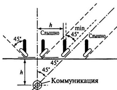
Рис. 19.4. Схема определения высотного местоположения подземной коммуникации при помощи прибора поиска
