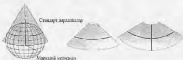
12.11-rasm. Konusli va kesishgan konusli proeksiyalar
