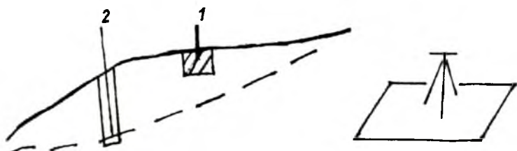
34-rasm. Surilma surilish tezligini aniqlash reperlarining joylashishi 1 — yuzaki, 2 — chuqurlik reperlari.
