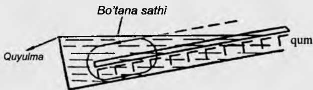
29-rasm. Reykali klassifikatorda eshkaklarning harakatlanish sxemasi
