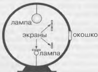
Рис. 1.15. ИНТЕГРИРУЮЩАЯ СФЕРА для измерения полного количества света, испускаемого лампой во всех направлениях. За окошком снаружи расположен фотометр, который сравнивает полные световые потоки двух ламп, включаемых по очереди.
