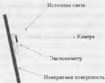
Рис. 1.12. Правильное измерение освещенности.
