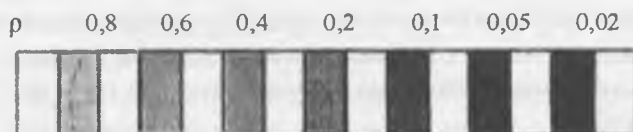
Рис. 4.20. Простейший визуальный измеритель светлоты.
