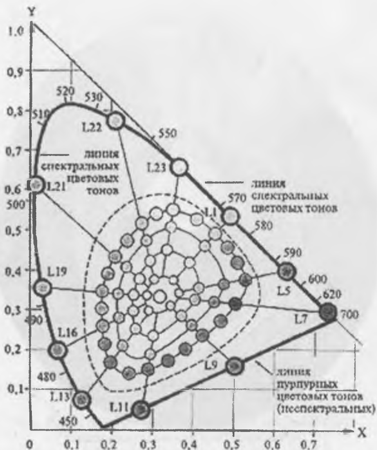
Рис. П.8. Цветовой график МКО (Международной комиссии по освещению) — инструмент исследований в области колориметрии и определения цветов. Здесь выявлена структура изменения насыщенности (чистоты) цвета нескольких основных цветовых тонов, расположенных на графике вдоль границы области цветности всех цветов, воспроизводимых монохроматическом светом.
