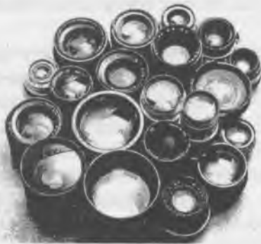
Рис.1.13. Объективы с многослойным просветлением, покрытие линз имеет характерный внешний вид.
