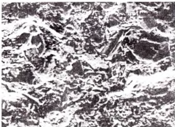
4.13-расм. Уяли райони тошсимон лёсслар синиқ юзаси бўйича 500 марта катталаштирилган сурати. ( В мегаструктура )
