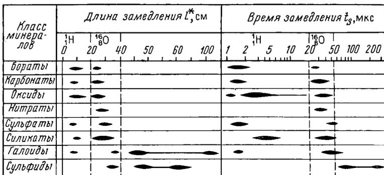
Рис. 80. Диапазоны изменения параметров замедления нейтронов в порообразующих минералах различных классов
