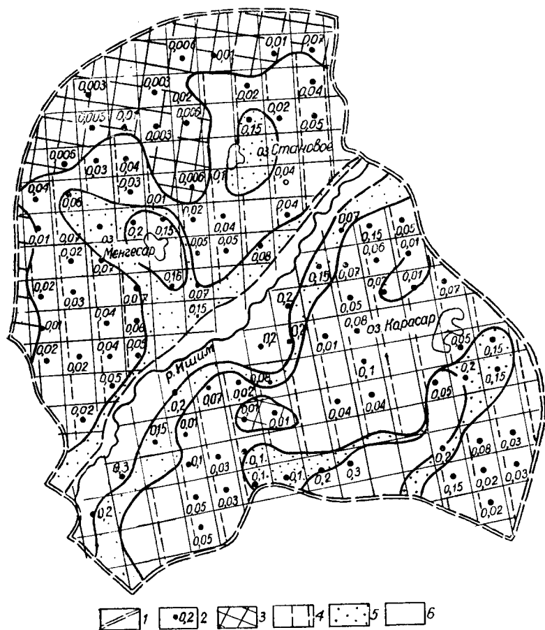
Рис. 13.1. Распределение величин инфильтрационного питания на территории Приишимской равнины (южная часть Западно-Сибирской низменности): 1 — границы расчетного участка; 2 — расчетный блок, цифра — величина инфильтрационного питания ( \text{л/с}\cdot\text{км}^2 ); 3–6 — инфильтрационное питание: 3 — менее 0,01 \text{л/с}\cdot\text{км}^2 ; 4 — 0,01–0,1; 5 — 0,1–0,2; 6 — 0,2–0,5 \text{л/с}\cdot\text{км}^2
