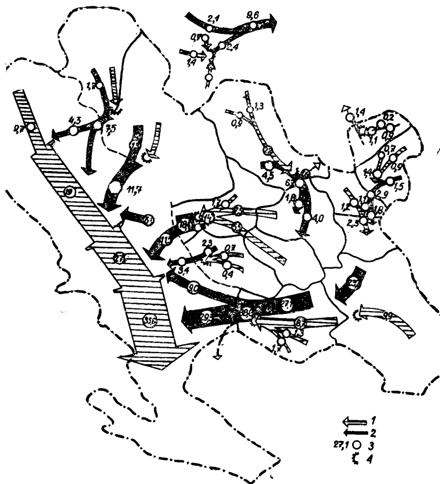
Рис. 9.8. Схема формирования потоков трещинно-карстовых подземных вод, бассейн р. Цетина, Динарийский массив, СФРЮ (по М. Коматину, 1975): 1 — потоки поверхностных вод (руслый сток), 2 — потоки трещинно-карстовых вод, 3 — расходы, м³/с, 4 — участки локального интенсивного поглощения поверхностных вод
