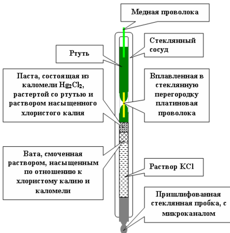
Рис. 13. Устройство каломельного электрода.
