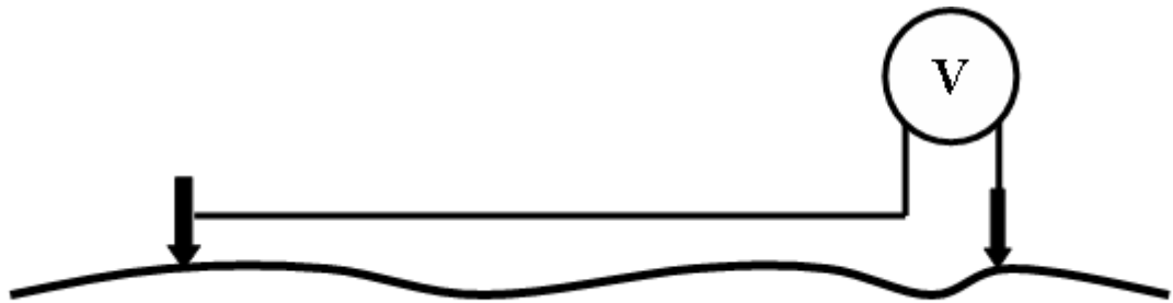
Рис. 2. Электроразведочная установка для измерения естественного электрического поля.
