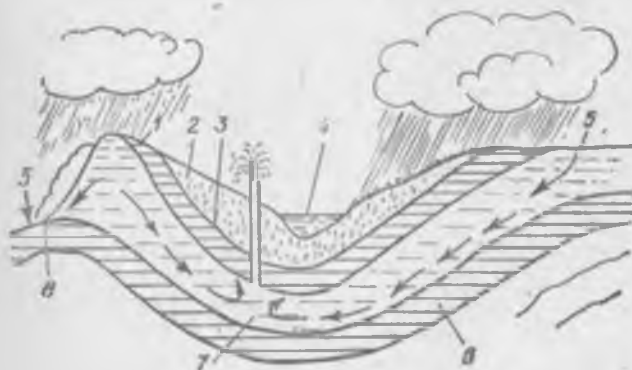
37-расм. Артезиан ҳавзанинг қирқими:
