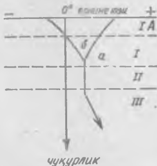
2-расм. Ер ичида температуранинг тақсимланиш схемаси
