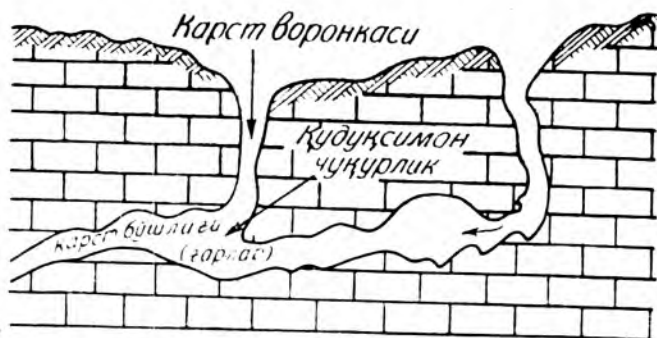
30-расм. Карст жараёнининг бошланиш ва ривожланиш схемаси.
