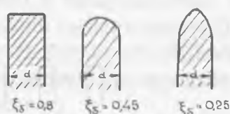
Рис. 12.5. Форма быков в плане и коэффициенты уменьшения
