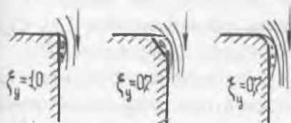
Рис. 12.4. Форма устоев в плане и коэффициенты уменьшения
