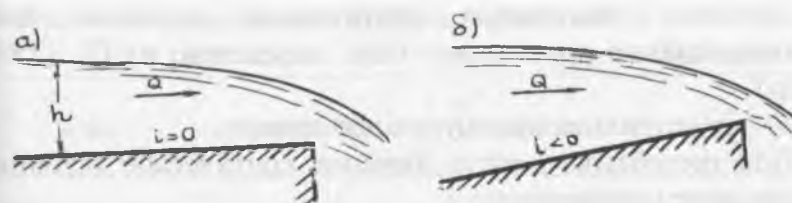
Рис. 10.2. Примеры неравномерного движения в цилиндрическом канале с горизонтальным дном и обратным уклоном
