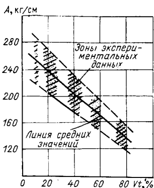
Рис. 64. Изменение сопротивления резанию углей A в зависимости от содержания компонентов группы витринита
