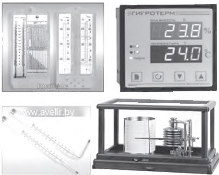
14-rasm. Harorat va namlikni o'lchaydigan asboblari
