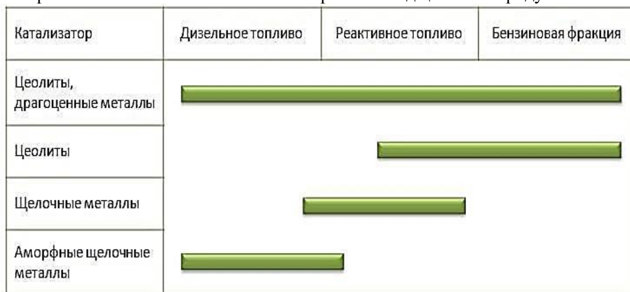
Рис. 1 – Зависимость выхода целевого продукта гидрокрекинга от состава катализатора [1]
