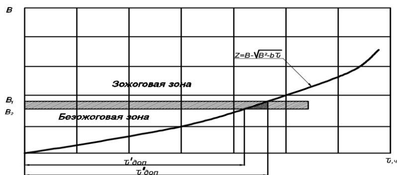
Рис. 1. Искомая закономерность возможного “термического ожога” долек дыни при сушке
