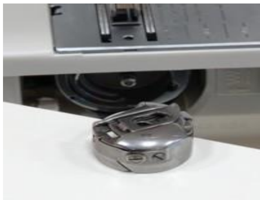
Рис. 2. Вертикальный, ротационный челнок
