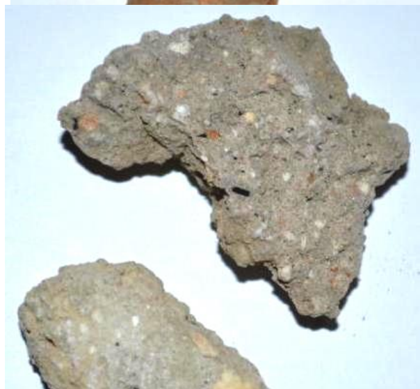
Расм-4. Исмоил Самоний мақбарасининг ўрганилган қоришма намуналари-1В (бино деворининг устки қисмидан)
