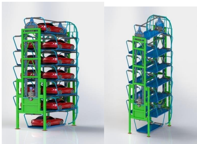
Mexanika asosi. Ushbu tizimning qurilishi oson bo'lib tuyulsa-da, materiallar, zanjirlar, dog'lar, rulmanlar, ishlov berish ishlari, kinematik va dinamik mexanizmlar haqida ma'lumotga ega bo'lmasdan tushunish qiyin bo'ladi. Aylanadigan model yoki to'xtash joyi rasmda ko'rsatilgandek bo'ladi. Barcha hisob-kitoblar amalga oshirildi va shunga ko'ra to'xtash tizimining har bir qismi haqiqatga aylantirildi.
