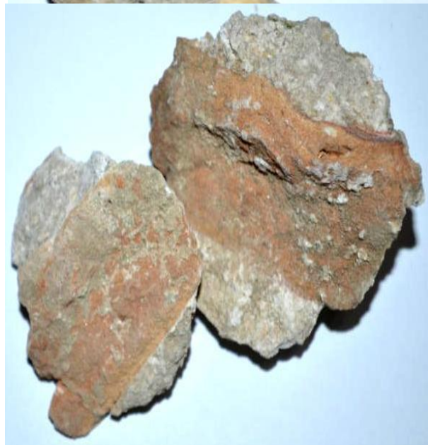
Расм-5. Исмоил Самоний мақбарасининг ўрганилган ғишт ва қоришма намуналари- 1С (бино деворининг остки қисми броз шўрланган)
