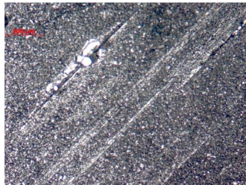
Расм.3. У8Г маркали пўлатдан тайёрланган арранинг электрон микроскоп остида кўриниши; а) азотлаш жараёни олдин б) азотлаш жараёни кейин
