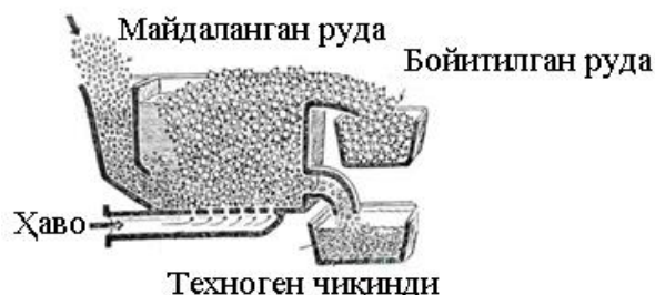
Расм.1.Флотация усулида бойитиш
