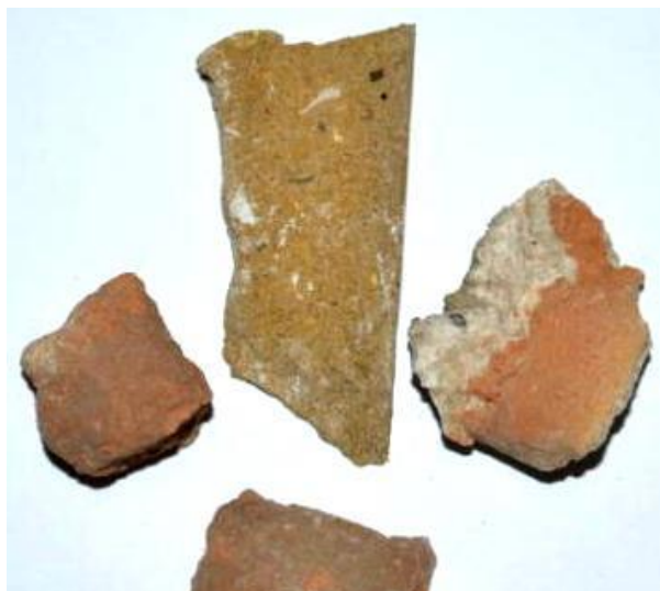
Расм-3. Исмоил Самоний мақбарасининг ўрганилган ғишт намуналари -1А (бино деворининг устки қисми)
