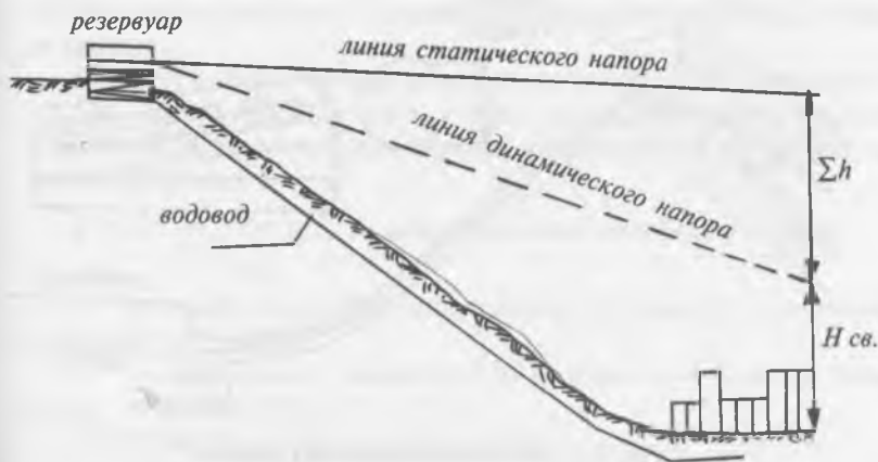
Рис. 9.1. Самотечно-напорный водовод
