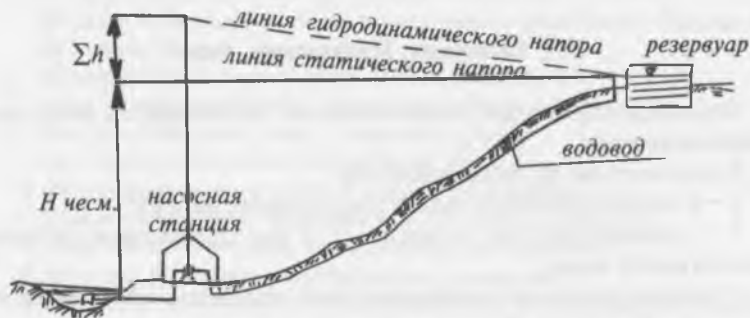
Рис. 9.2. Нагнетательно-напорный водовод
