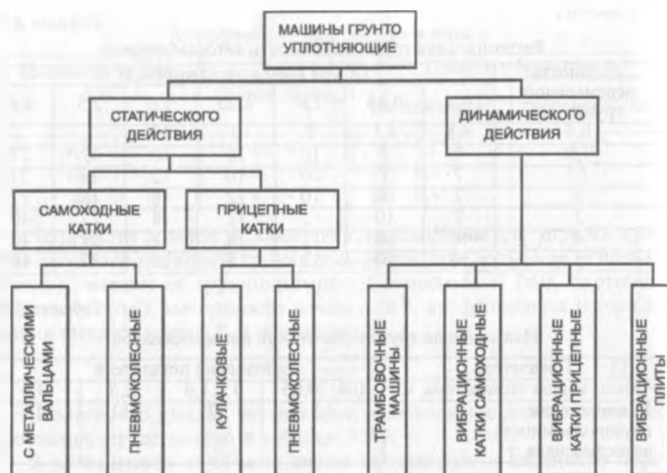
Рис. 2.10.1. Классификация выпускаемых грунтоуплотняющих машин.
