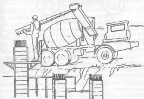
Рис.3.3.1. Автобетоносмеситель со специальным лотком.
