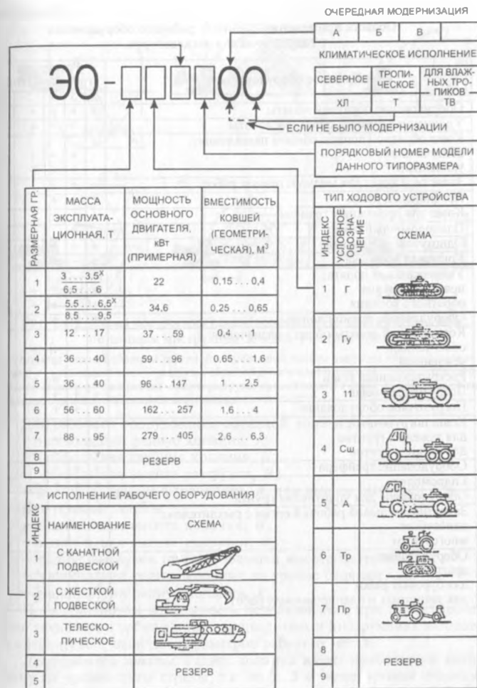
Рис. 2.6.1. Структура индекса одноковшовых экскаваторов.
