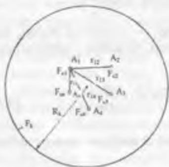
4.2-rasm. Uzoqlashgan iste'mol konturili qatlamdagi quduqlar guruhi sxemasi.
