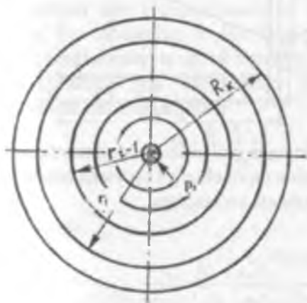
3.10-rasm. Zonal bir jinsli bo'lmagan qatlamning gorizonttal kesimi.
