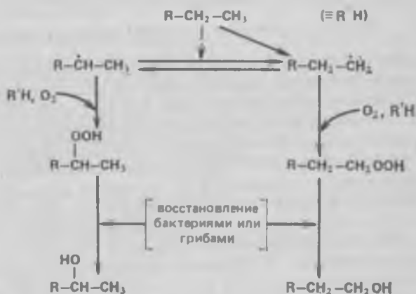
Рис. 3.3. Схема образования гидроперекисей с участием свободнорадикальных промежуточных продуктов
