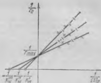
Рис. 6.6. Зависимость обратных величин r_0 и [S]_0 при полном конкурентном ингибировании
