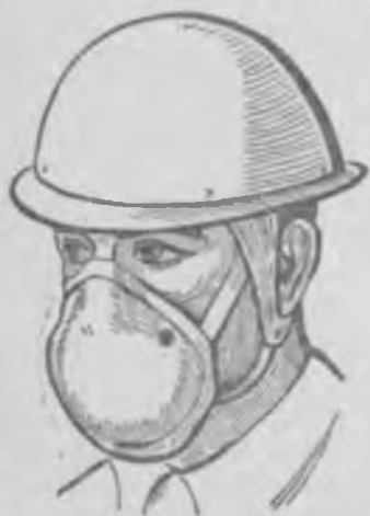
Рис. 7.25. Фильтрующий противопылевой бесклапанный респиратор ШБ-1 «Лепесток» в рабочем положении
