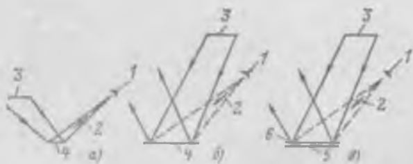
Рис. 11.5. Схемы расположения светильника, рабочей поверхности и работающего:
