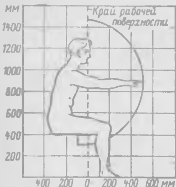
Рис. 9.9. Зона досягаемости моторного поля в вертикальной плоскости для человека среднего роста в положении сидя
