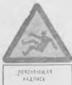
Рис. 8.1. Предупреждающий знак безопасности с дополнительной табличкой
