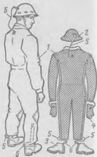
Рис. 10.25. Экранирующий костюм: 1 — комбинезон из токопроводящей ткани; 2 — каска металлическая или металлизированная; 3 — ботинки с электропроводящей подошвой; 4 — рукавицы; 5 — проводники, обеспечивающие электрическую связь отдельных элементов экранирующего костюма; 6 — вывод от токопроводящей подошвы
