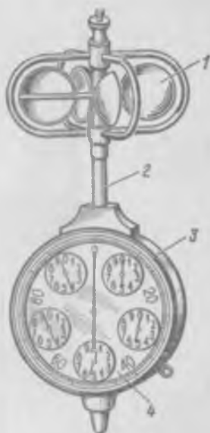
Рис. 10.2. Чашечный анеометр, измеряющий скорость движения воздуха в пределах 0,5—18 м/с:
