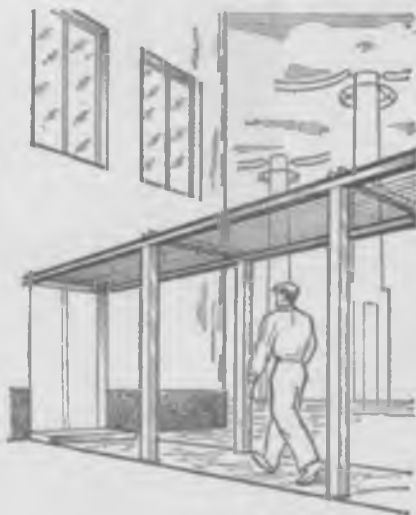
Рис. 10.23. Стационарный охраняющий навес над проходом в здание
