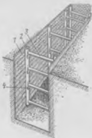
Рис. 3.7. Распорное крепление траншей:
