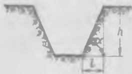
Рис. 3.9. Котлован (траншея) с откосами без креплений:
