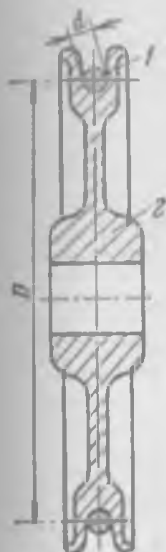
Рис. 4.2. Блоки грузовые механические одно- и многороликовые, конструкция которых исключает спадание каната
