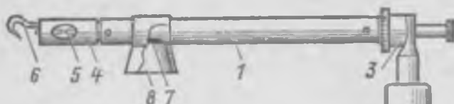
Рис. 7.9. Указатель напряжения (рабочая часть) 2—10 кВ с искровым промежутком и затеняющим колпачком, навинченный на изолирующую штангу и предназначенный к использованию в электроустановках выше 10 кВ:
