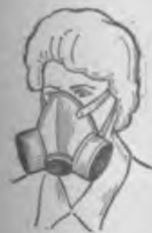
Рис. 7.23. Фильтрующий противогазовый респиратор РПГ-67 в рабочем положении
