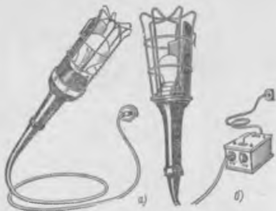
Рис. 11.11. Ручные переносные светильники для напряжений 127—220 В (а) и 12—42 В (б)
