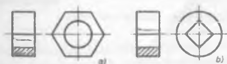
97-shakl. Detalning tashqi (a) va ichki (b) qirralari simmetriya o'qi bilan ustma-ust tushganda qirqimlardan o'rinli foydalanishga misol
