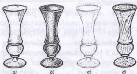
80-shakl. Metall (a), tosh (b), shishadan (s) va yog'ochdan (d) tayyorlangan detallar-ning texnik rasmlari
