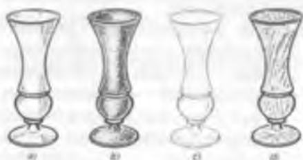
80-shakl. Metalldan (a), toshdan (b), shishadan (s) va yog'ochdan (d) tayyorlangan detallar-ning texnik rasmlari
