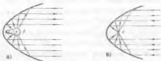
45-shakl. Parabolik qaytargichlarning amaliyotda qo'llanilishiga misollar: a) yoritish asboblari; b) teleskop, radiolokator va antennalarda
