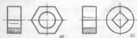
97-shakl. Detalning tashqi (a) va ichki (b) qirralari simmetriya o'qi bilan ustma-ust tushganda qirqimlardan o'rinli foydalanishga misol
