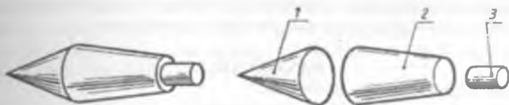
111-shakl. «Konus» detali geometrik shaklini geometrik jismlarga ajratib tahlil qilishga misol: 1 – konus; 2 – kesik konus; 3 – silindr
