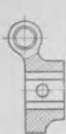
Рис. 242. Соединение части вида с частью разреза
