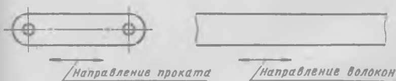
Рис. 326. Указания о направлении проката, волокон
