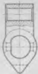
Рис. 242. Соединение части вида с частью разреза
