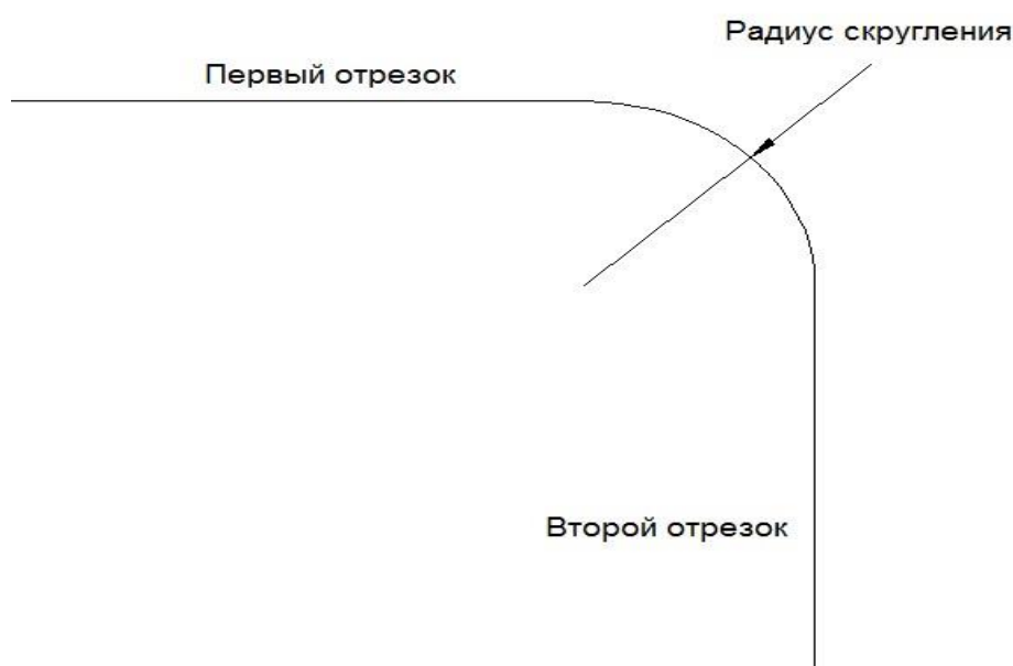
Рис. 13.12 Построение сопряжения в системе AutoCAD
