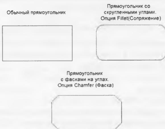
Рис.12.1. Варианты построения прямоугольников в системе AutoCAD
