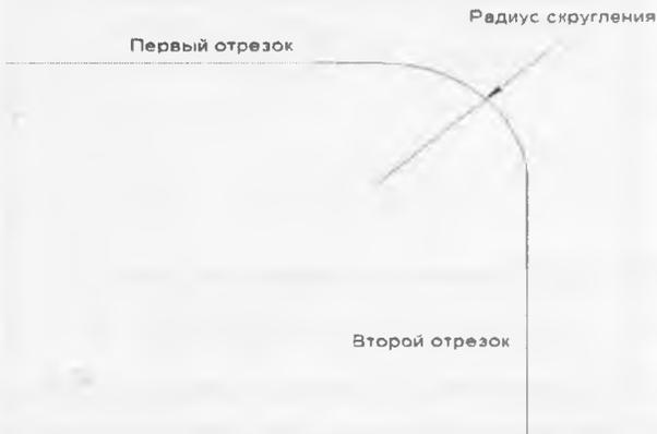
Рис. 13.12 Построение сопряжения в системе AutoCAD
