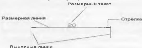
Рис 14.6 Структура размера в AutoCAD.
