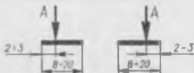
97-шакл. Кесувчи текислиكنинг йўналишини кўрсатиш
