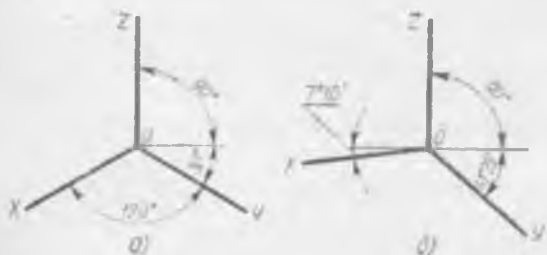
118-шакл. Тўғри бурчакли аксонометрик ўқлар вазияти
