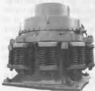
20-rasm. KSD-1750T modeli o'rta maydalaydigan konusli maydalagich.
