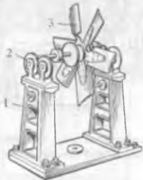
20.36-rasm. Ventilyatorni muvozanatlash: 1-stend; 2-roliklar; 3-kuraklar.
