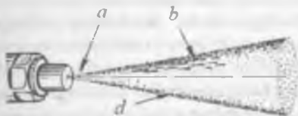
18.14-rasm. Forsunka orqali purkalgan yoqilg'i changining oqimi: a -yoqilg'ining chiqishi; b -chang bo'laklari; d -yoqilg'i changining normal oqimi.
