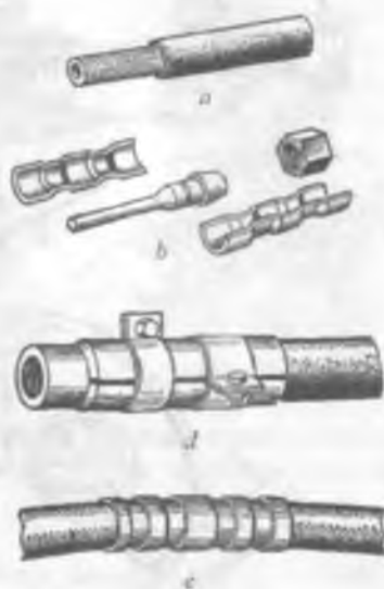
20.40-rasm. Yuqori bosimli rezina quvurlarini ta'mirlash: a-tozalangan shlang; b-yig'uvchi mufta; c-tiklangan shlang; d-ulanang shlang.
