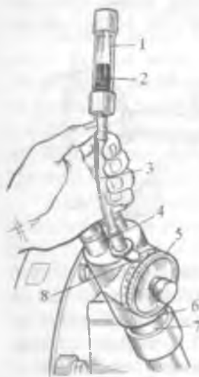
18.1-rasm. KH-13671 rusumli indikator: 1-shisha tirqishli raycha; 2-porshen; 3-uzaytirgich; 4-tiqin; 5-qopqoq; 6-korpus; 7-bog'lagich; 8-raqamli ko'rsatkich.
