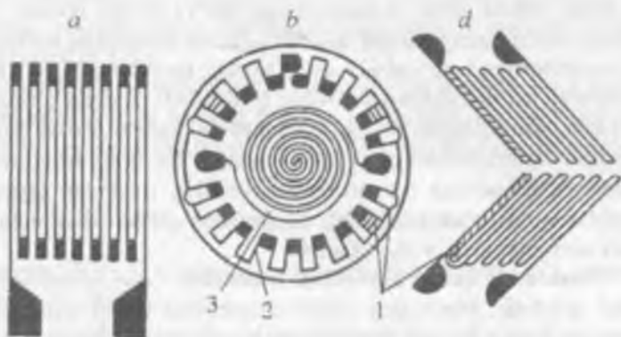
2.3-rasm. Folgalı tenzodatchik: a -chiziqli deformatsiyani o'lchash uchun; b -boshimni o'lchash uchun; d -valdagi momentni o'lchash uchun; 1-to'g'irlagich; 2-cho'zilishni aniqlovchi sezgir qatlamlar; 3-siqilishni aniqlovchi sezgir qatlamlar.
