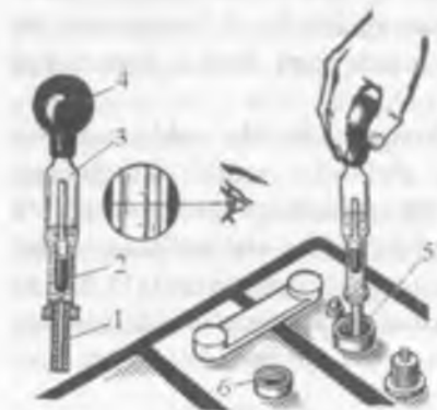
18.24-rasm. Elektrolitning zichligini tekshirish: 1-shishali naycha; 2-areometr; 3-kolba; 4-rezinali so'rgich; 5,6-quyish teshiklari.
