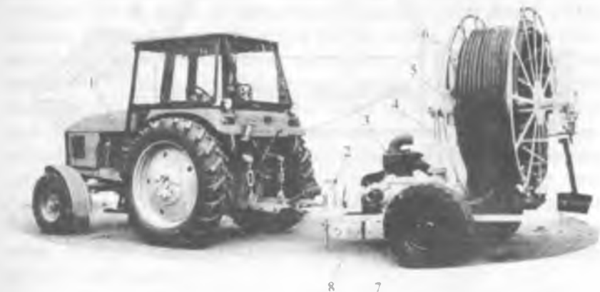
13.2-rasm. ПДТП-200 rusumli drenaj quvurlarini tozalovchi mashina: 1-traktor; 2-arava ramasi; 3-suv nasosi; 4-nasosning bosim quvuri; 5-gʻaltak; 6-rezina quvur oʻrami; 7-aravaning gʻildiragi; 8-nasosning soʻruvchi quvur bogʻlagichi.
