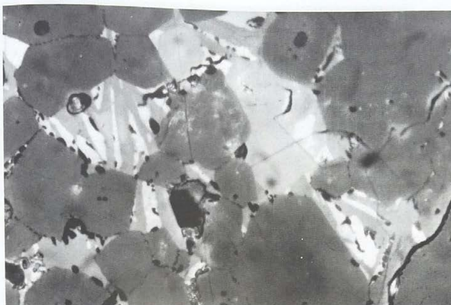
Рис. 2.13. Призматические кристаллы C_3A (серые зерна) и свободный CaO (круглые белые частицы) включены в фазу застывшего расплава
