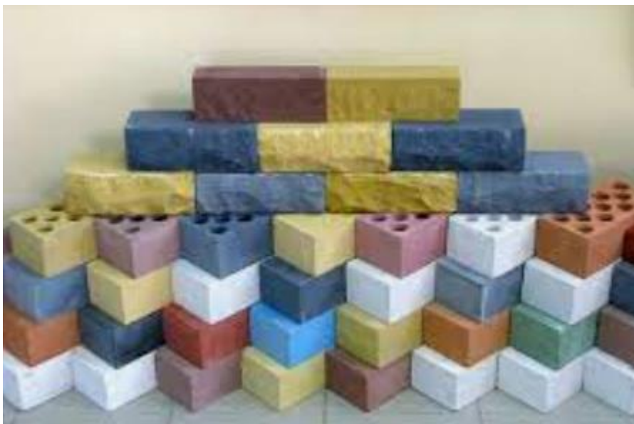
9.3-rasm. Tarkibiga ishqorga bardoshli pigmentlar kiritilgan silikat g'ishtlarning ko'rinishi.
