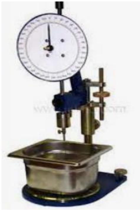
12.1-rasm. Penetrometr bitumlarning qovushoqligini laboratoriya sharoitida aniqlash asbobi.
