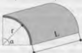
12.1-rasm. Zavodda tayyorlangan gipskartonli egik elementlar
