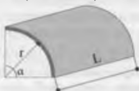
12.1-rasm. Zavodda tayyorlangan gipskartonli egik elementlar
