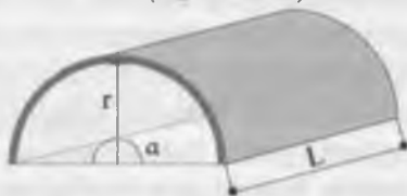
12.1-rasm. Zavodda tayyorlangan gipskartonli egik elementlar
