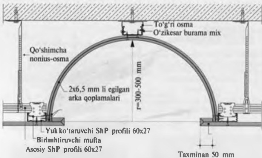
12.9-rasm. Osma shift tarkibidagi silindrik gumbaz.
