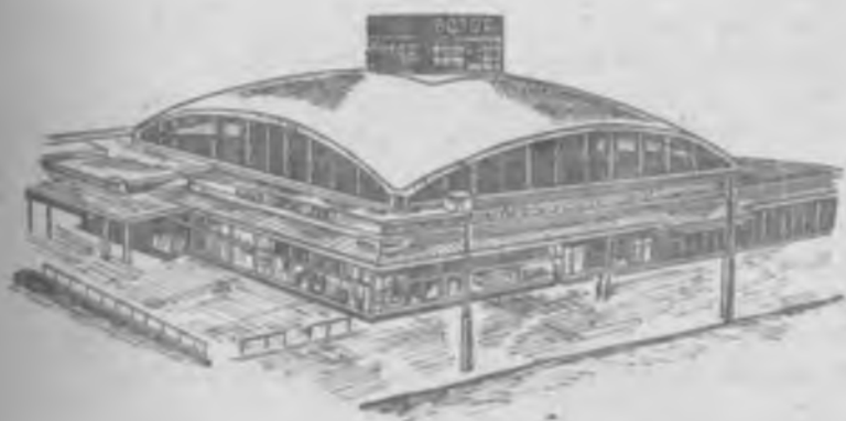
15.20-расм Қўшалоқ гаусс мусбат эгрилигига эга бўлган темир-бетон кобикдан тайёрланган ёппа
