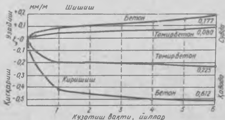
3.7- расм. Бетон ва темир-бетонда вақт мобайнида чуқиш деформацияси ва кўпчишнинг ривожланиши.
