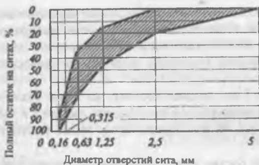
Рис.6.1. График зернового состава песка.
