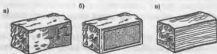
Рис. 2.3. Блоки: а - колотый; б - тесаный; в - пиленный.
