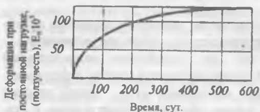
Рис. 6.9. Развитие ползучести бетона по времени.
