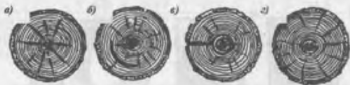
Рис. 13.4. Разновидности трещин древесины: а) метик; б) кольцевой отлуп; в) морозная трещина; г) трещины сушки.
