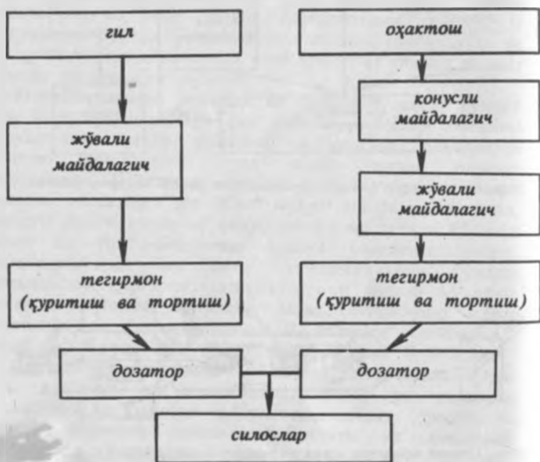
52-расм. Қуруқ усул билан портландцемент ишлаб чиқариш схемаси.
