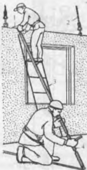
56-расм Devor panelini o'rnatish: 1—strubsina; 2—strop; 3—tirgak; 4—tortish muftasi.
