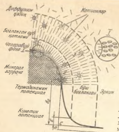
1.6-расм. Минерал заррачалари юзаларининг сув билан ўзаро электромолекуляр таъсири схемаси; 1 — минерал заррача; 2 — боғланган сув; 3 — бўш боғланган сув.
