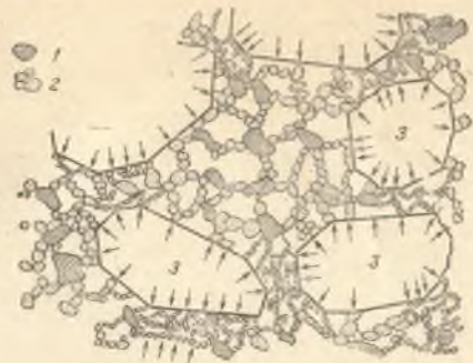
1.7-расм. Лойли грунтларнинг структуралари; 1 — лой заррачаляги; 2 — эчялинан коллоидлар; 3 — кум доналары.
