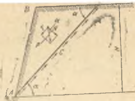
VI.3-рasm. Соф боғланишли грунтдан ташкил топган қияликда олинган грунт заррачасига таъсир этувчи кучлар схемаси.
