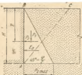
VI.13-расм. Ички томони текис вертикал ҳолдаги тиргович деворга таъсир этувчи кучлар таъсирланган чизма.
