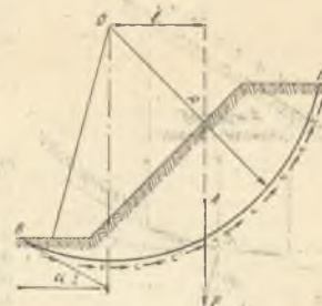
VI.7-расм. Қиялик турғунлигини айланма цилиндрик юза бўйлаб силжиш усули билан ҳисоблаш схемаси ( \varphi = 0 бўлган ҳолат).
