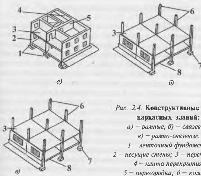
**Рис. 2.4. Конструктивные схемы каркасных зданий:**
