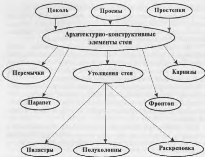
Рис. 2.7. Кластер-схема архитектурно-конструктивных элементов стен
