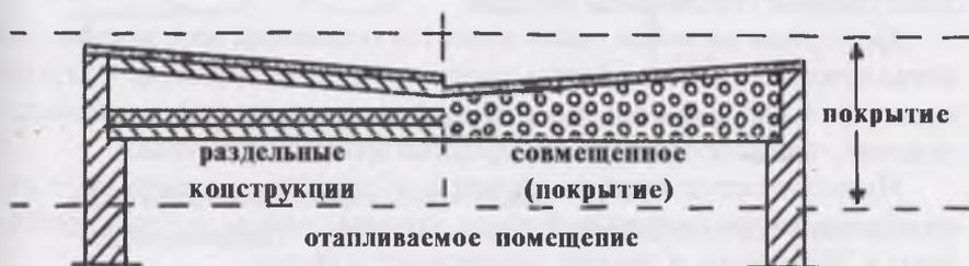
Рис. 2.25. Бесчердачная крыша
