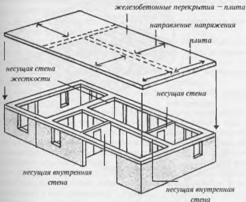
Рис. 2.16. Железобетонные перекрытия
