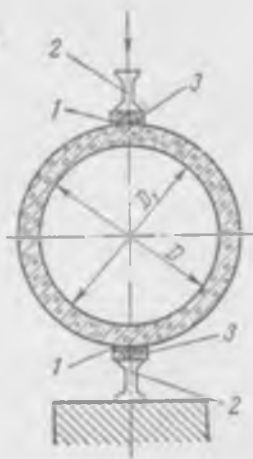
Рис. 85. Схема определения механической прочности трубы по отношению к внешним нагрузкам
