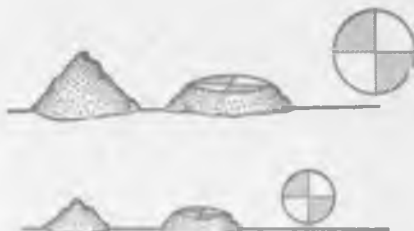
Рис. 6. Сокращение средней пробы методом квартования
