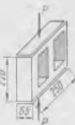
Рис. 82. Схема испытания вертикальной части фасадных плит
