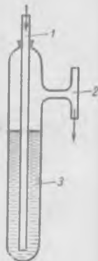
Рис. 34. Гидравлический регулятор разрежения
