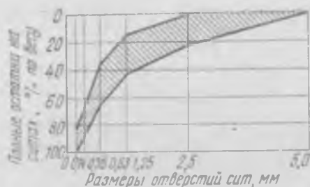
Рис. 36. Кривая просеивания песка
