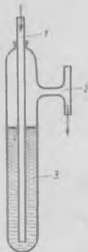
Рис. 29. Гидравлический регулятор разрежения
