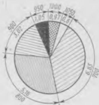
Рис. 51. Диаграмма теплоты смачивания водой кирпича при разных температурах обжига
