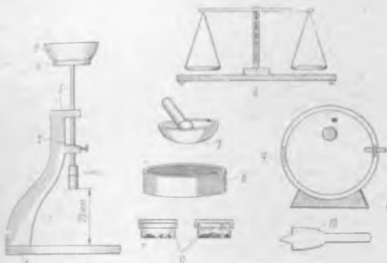
Рис. 24. Аппаратура, используемая для определения пластичности глинистого сырья по методу А. М. Васильева:
