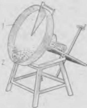
Рис. 55. Тарельчатый гранулятор:
