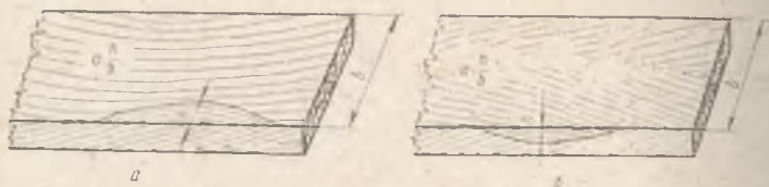
Рис. 60. Определение размера завитка на доске: а) радиальной; б) тангентальной распиловки
