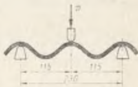
Рис. 15. Схема испытания образца на прочность при изгибе
